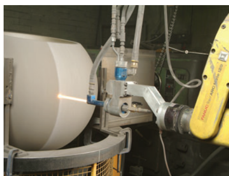
JetKote® High Velocity Oxy-Fuel spraying of 42" diameter ball valve. JetKote® (ジェットコート) による直径42インチボールバルブのHVOF溶射法 高速フラーム溶射
