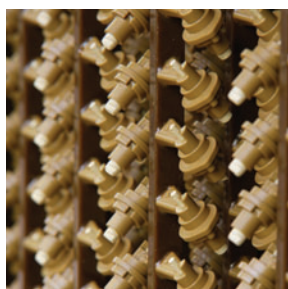
Assembled components ready to be dipped; very precise internal geometry is realized with a ceramic core. 浸漬前のアセンブルコンポーネント；セラミックコアにより非常に高精度な形成を実現
